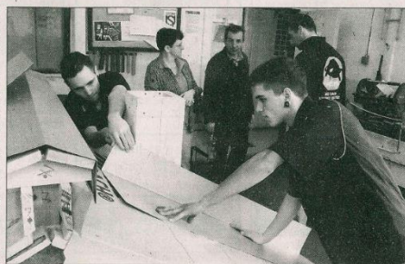
Základní osazení u klenčířů. Michal Tamchína (široce) a Jaroslav Borský při plnění soutěžního úkolu. Během něj měli provést oplechování makety sedlové střechy s komínem a arkýřem.
